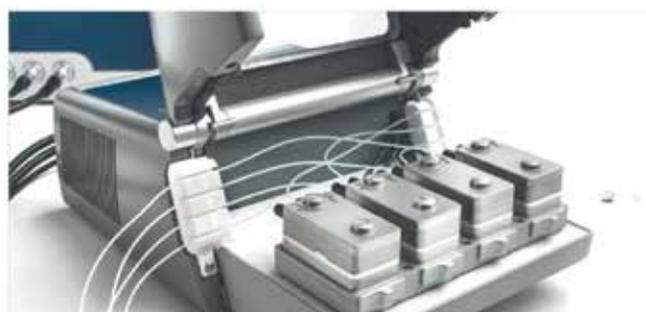
Для четырех отдельных каналов для ввода образцов параллельно выполняются четыре измерения.
